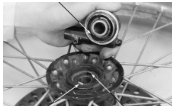
RETENTOR DE PÓ PRENDEDOR DA ENGRENAGEM DO VELOCÍMETRO
