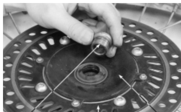
ESPAÇADOR DISCO DE FREIO CUBO
