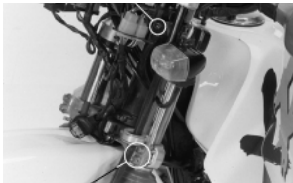
PARAFUSO DE FIXAÇÃO INFERIOR
