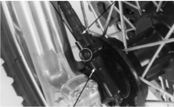
CAIXA DA ENGRENAGEM DO VELOCÍMETRO
