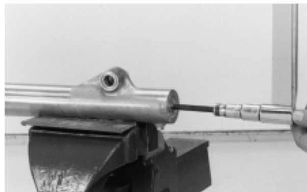
GUIA INSTALADOR DO RETENTOR DE ÓLEO
