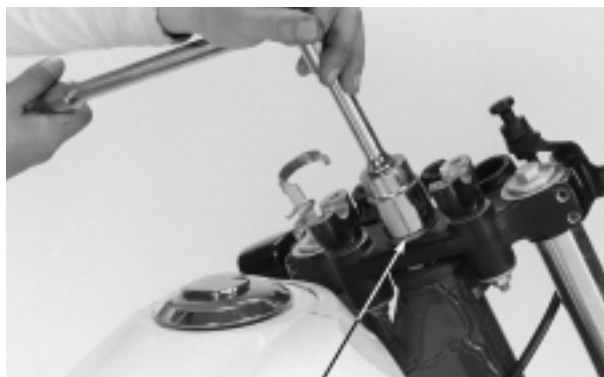
PORCA DA COLUNA DE DIREÇÃO
