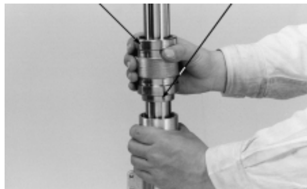
GUIA INSTALADOR DO RETENTOR DE ÓLEO
