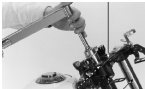
PORCA DA COLUNA DE DIREÇÃO
