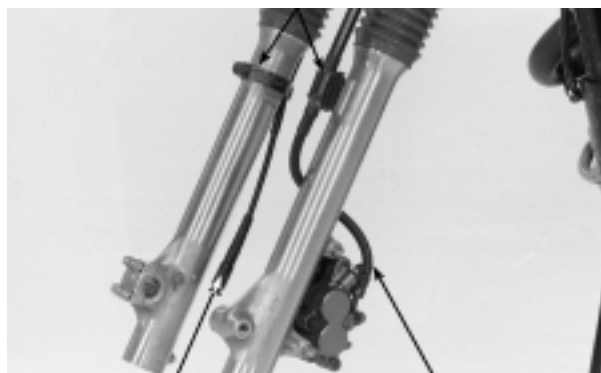
CABO DO VELOCÍMETRO
